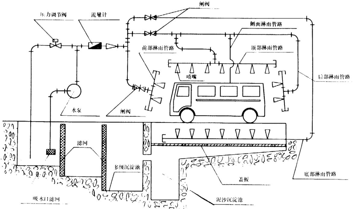
图 B1 淋雨系统设备示意图
