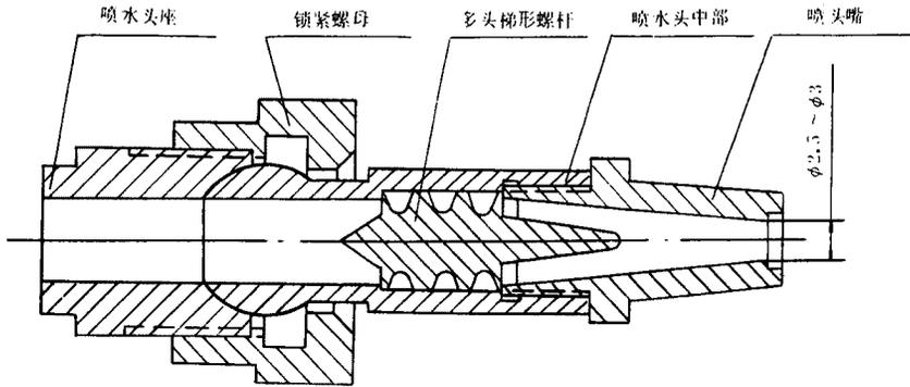
图 B3 专用喷嘴结构示意图
