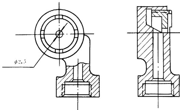
图 B2 尼龙喷嘴结构示意图
